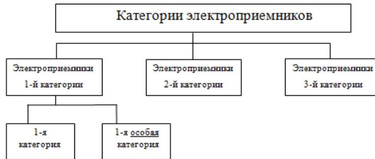
Рис. 1.1. Категории электроприемников по надежности электроснабжения
